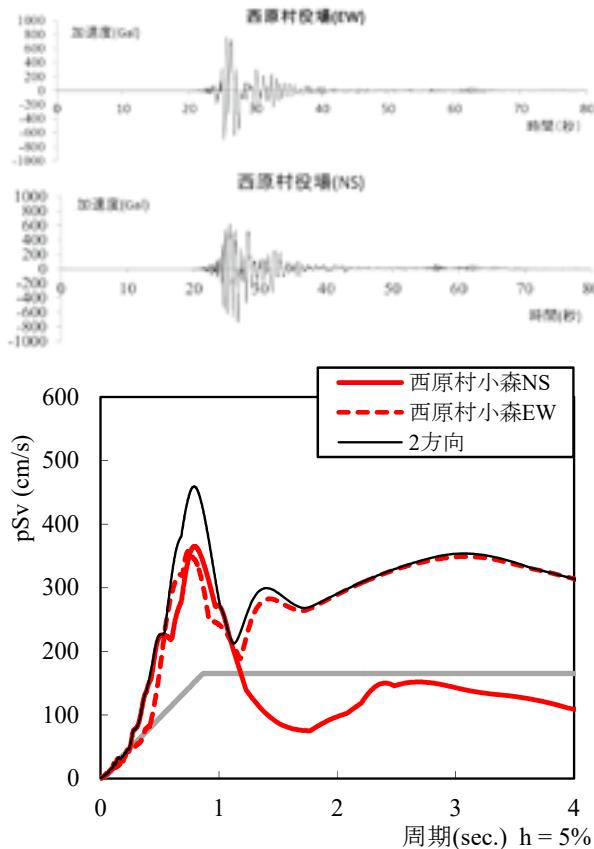
図 1.1.6 西原村役場で観測された地震動波形と応答スペクトル（中川博士提供）
