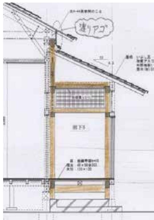
図 2.11.1 トラスの渡り額仕口に柱を建て基礎まで伝える
